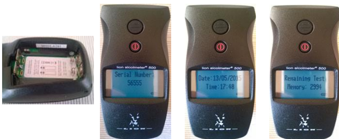
Slika 2. Prikaz mjesta gdje je zalijepljena traka s upisanim serijskim brojem uređaja i LCD zaslona u samotestiranju
