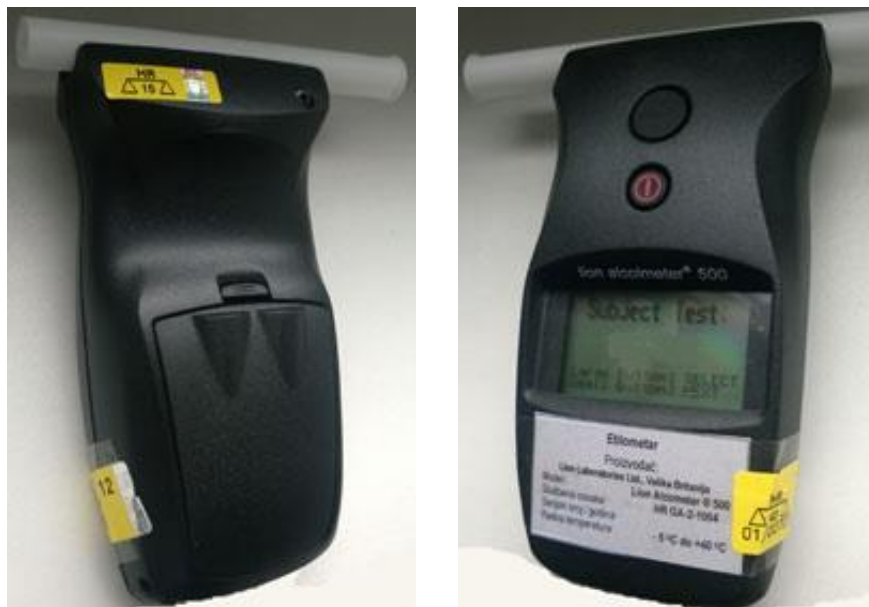
Slika 6. Uređaj Lion Alcometer® 500 prikaz s obje strane – mjesta za ovjernu i zaštitno naljepnicu
