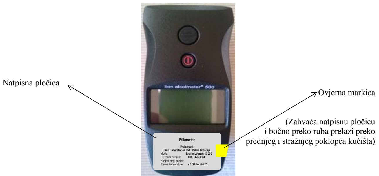
Slika 5. Postavljanje natpisne pločice i ovjerne markice – pogled s prednje strane
